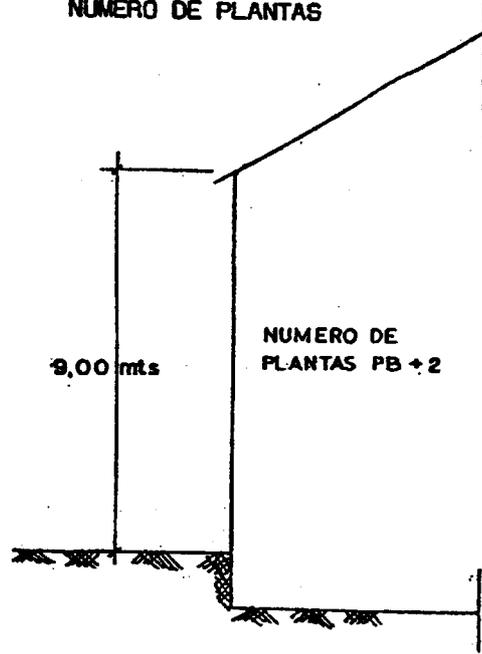
Art. 34.3.- ALTURA MAXIMA VISIBLE DEL EDIFICIO
